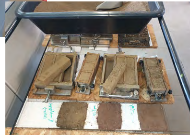
Test de production de BTC (haut), essais de retrait (milieu), test de résistance à la compression (bas). © Laboratoire Piment
